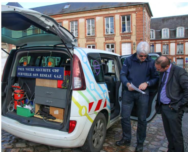
**Le véhicule de surveillance réseau est équipé de capteurs, 10000 fois plus sensibles que le nez humain.**
