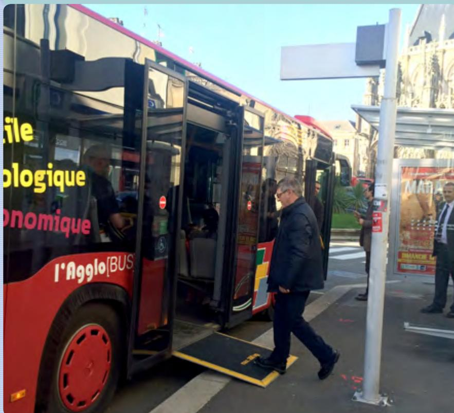
**Chaque bus est équipé d'une palette permettant aux fauteuils de monter et descendre du véhicule sans difficulté.**
