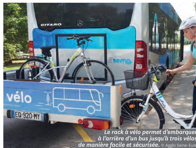
Il a fallu deux années pour permettre son développement, sa réalisation et son homologation. Le rack à vélo est en service depuis le 16 septembre. Il permet d'embarquer trois vélos, verrouillés automatiquement par le chauffeur. Il est utilisable sur une partie des rotations de la ligne 1 (Louviers-gare SNCF) du réseau Semo. Une innovation pour la combinaison de deux modes de transports qui sont plus que jamais dans l'ère du temps.
